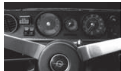
...und der Drehzahlmesser sitzt zwischen Tacho und Kombiinstrument
