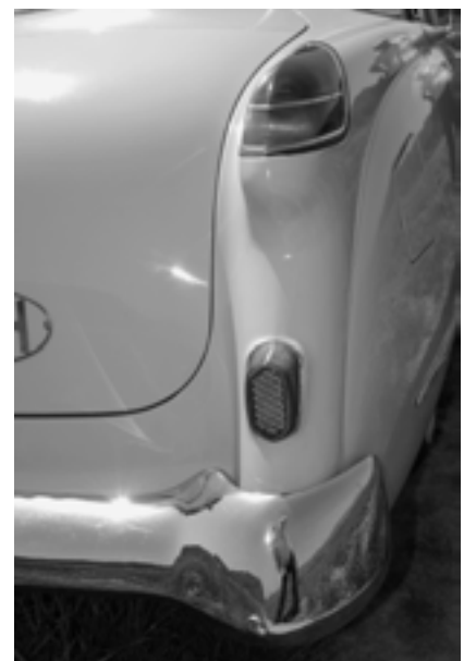
Spaß und Ernst – die konturierten Stoßstangen erfreuen das Auge, die verschraubten und damit im Bedarfsfall leicht zu wechselnden Kotflügel den Geldbeutel
