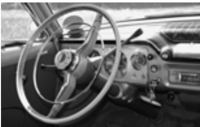
Wie eine Wurlitzer Jukebox wirkt die Brücke, pardon, das Armaturenbrett – aber nur auf den ersten Blick, denn erste Ansätze zur Verbesserung der passiven Sicherheit finden sich schon im Kapitän '54. Das Armaturenbrett ist oben zum Schutz vor Spiegelungen geschwärzt. Dafür zielt die ungeteilte Lenksäule direkt auf des Fahrers Brustbein, und die Stockhandbremse auf sein Knie
