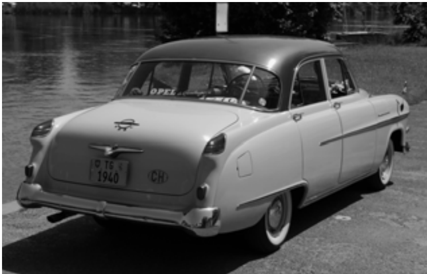
Der Zeit voraus – schlichte Pontonform ohne angedeutete Kotflügel, und bereits mit kleinen Heckflossen...
