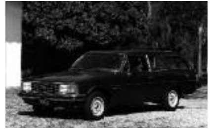
Völlig anders wirkte der Caravan Comodoro des Jahrganges 1983. Die Front geglättet, die Motorhaube ebenfalls, die Stoßstangen mit Gummiauflage, die Flanken mit Gummileisten
